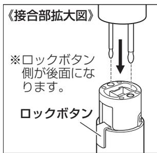
棒と穴の太さを確認して、2本の棒を同時に差し込みます。
