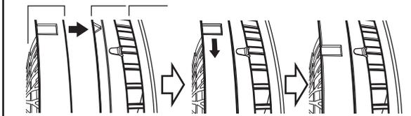
後ガードの△に、前ガードの□を合わせて押し込む ③
